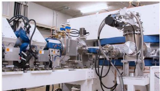
サイクロトロン(照射用及びホウ素薬剤製造用)
