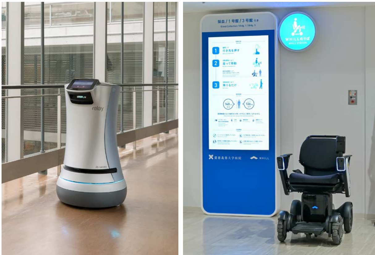
〔図2〕院内で動いている搬送ロボット（左）薬剤・検体搬送ロボット（右）人搬送ロボット
